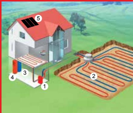
**Pompa di calore terra con collettore piano**
