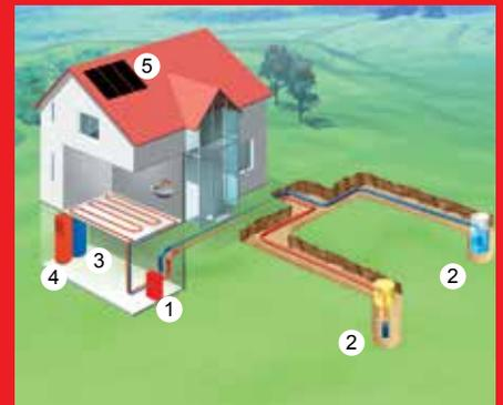
**Pompa di calore terra con acqua di falda**
