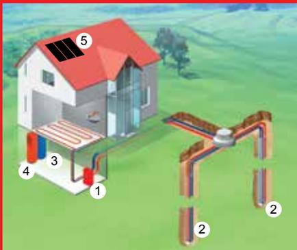
**Pompa di calore terra con sonda geotermica**
