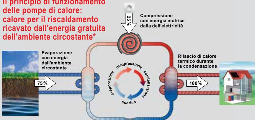
In un processo ciclico a 4 stadi, le pompe di calore generano il calore di riscaldamento dall'energia gratuita dell'ambiente circostante:
